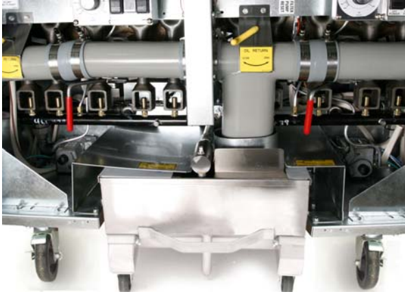
Çoklu fritöz sistemindeki tipik bir Alt Fritöz Filtresi (UFF - Under Fryer Filter).
