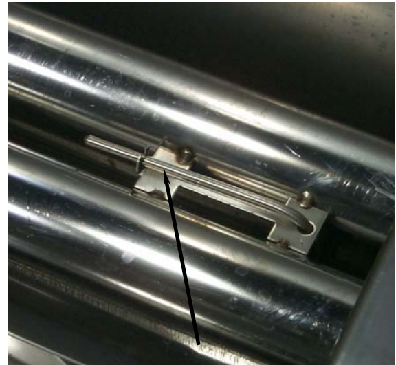
Kızartma kabında elektronik termostat probu (ok).
